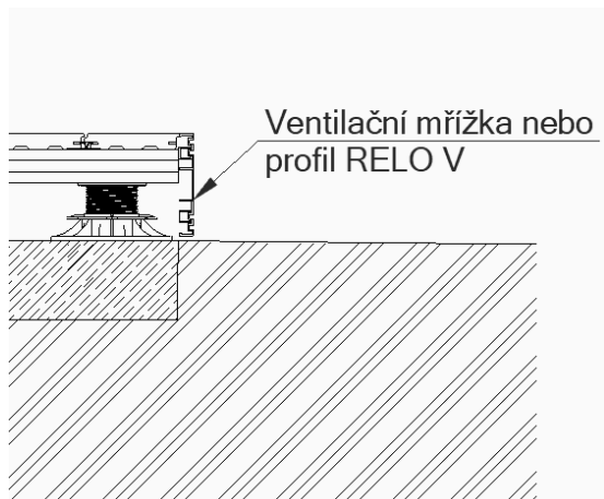
Obr. 6 Příklad montáže ventilační mřížky pro zakrytí nosné konstrukce
